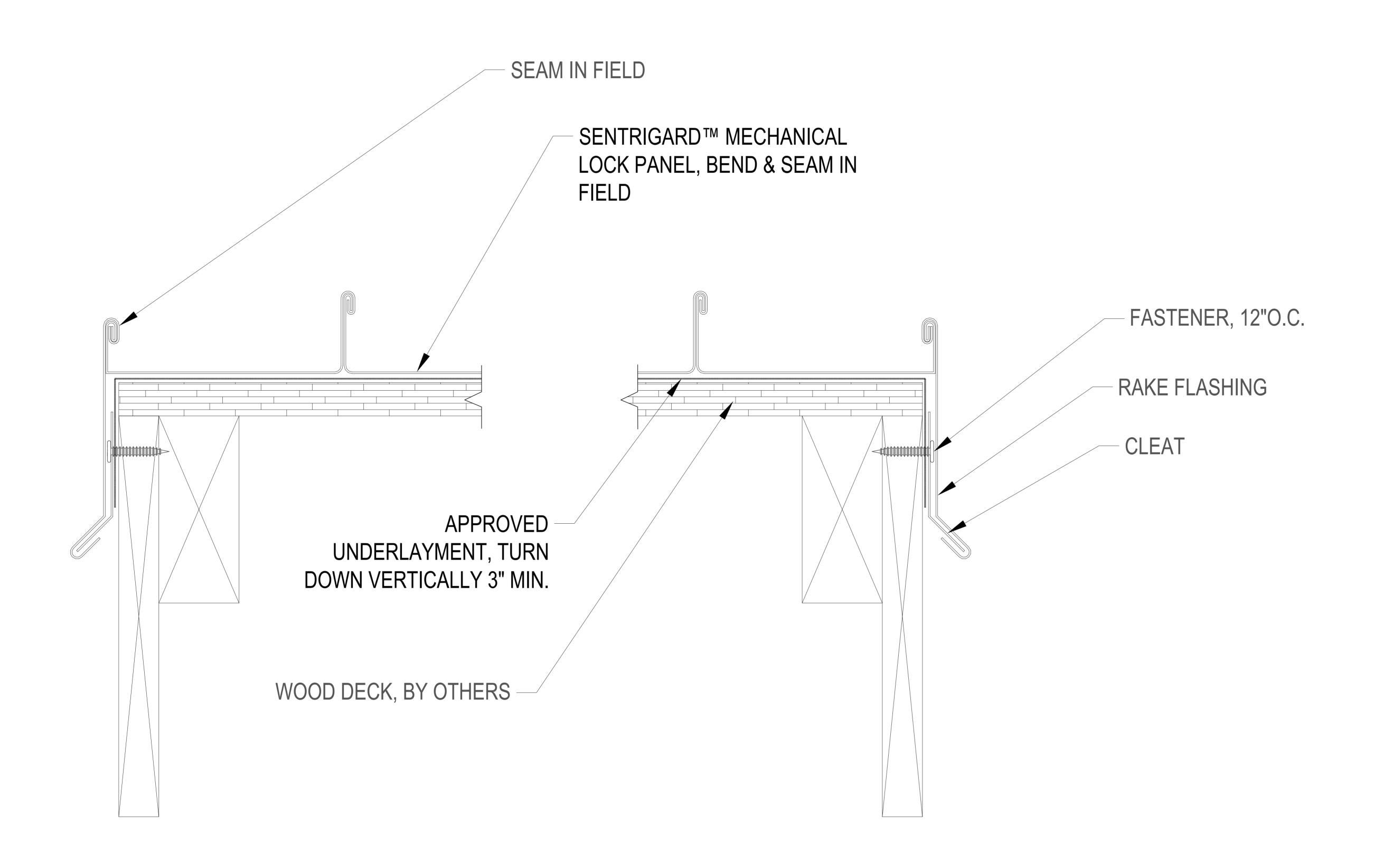
\*\*\*DETAILS SHOWN FOR ILLUSTRATION PURPOSES ONLY. -FASTENERS MUST PENETRATE DECK PER POSTED SENTRIGARD TESTING -FASTENER SPACING MUST BE BASED ON PROJECT SPECIFIC LOADS
